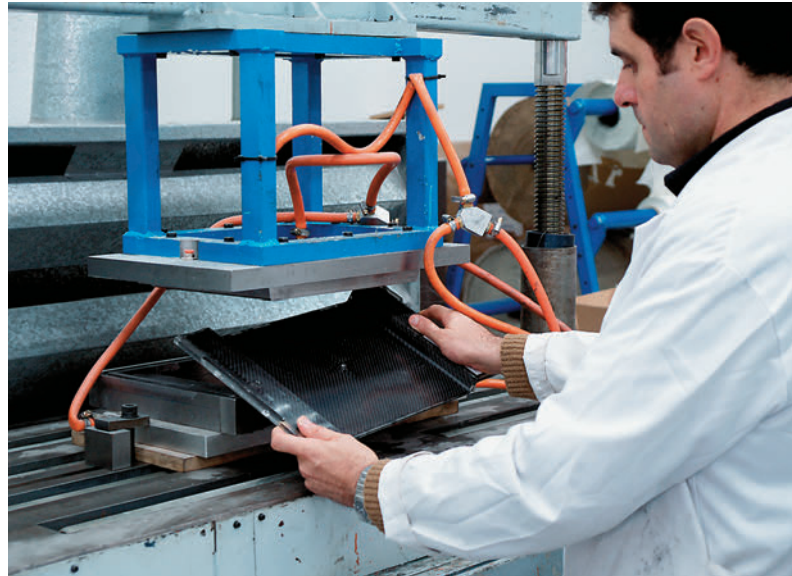
Zenbait pieza RTM (Resin Transfer Moulding) prozesuaren bidez eraldatzen dituzte, eta ezaugarri bikaineko egitura-piezak lortzen dira.
