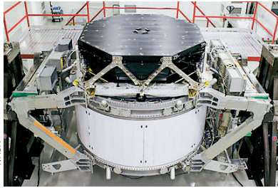
Goiko argazkian, AMS espektrometroa ageri da. Horrekin, materia iluna eta antimateria nahi zituzten ikertu ISSn. Eskuineko argazkian lau ki gorri batez nabarmenduta dagoen lekuan jarri nahi zuten. Alabaina, ez dute inoiz ISSra bidaliko.
