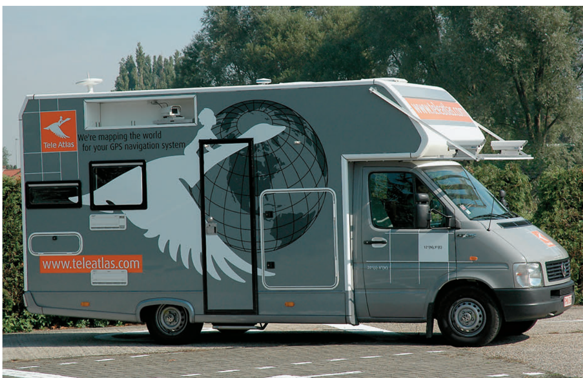
Kartografia mugikorrerako ibilgailuak GPS nabigatze-tresnen mapak sortzeko datuak jasotzen ditu.
