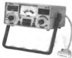
Permite verificar a emissão de cada canhão do cinescópio em prova e reativá-lo, possui galvanômetro com precisão de 1% e mede MAT até 30 kV.
