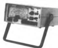
Sete escalas de frequências: A - 100 a 250 kHz, B - 250 a 650 kHz, C - 650 a 1700 kHz, D-1, 7 a 4 MHz, E - 4 a 10 MHz, F - 10 a 30 MHz, G - 85 a 120 MHz, modulação interna e externa
