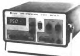
Fonte digital continuamente variável de 0 a 35 V, corrente máx. de saída 2 A, proteção sobrecarga. Voltímetro eletrônico de 0,1-1000 Vc.c. c/ impedância de entrada 10 MΩ, precisão de 1%.
