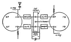
FIG. 5—THE SCHEMATIC DIAGRAM OF THE SUPER-REGENERATIVE CIRCUIT IS GIVEN ABOVE
