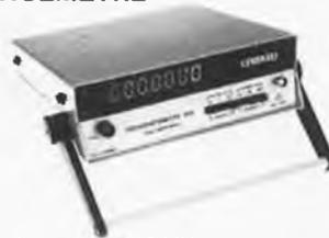
Fréquence 1 Hz à 600 MHz
