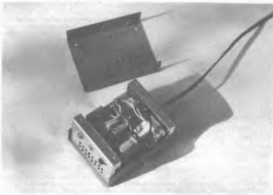
figura 13 Il termometro aperto è visibile la sezione alimentatrice il cui circuito stampato non è descritto nel testo Il circuito del termometro vero e proprio si trova nella parte opposta del contenitore.
