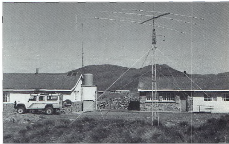
Vue sur le site avec l'antenne Explorer-14 sur son pylône de 8 m. Notez la présence des antennes VHF dans le fond qui sont le seul lien avec la civilisation lorsque la neige bloque les chalets.
