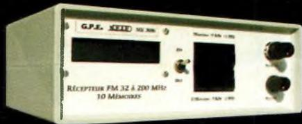
Nouveau à synthèse de fréquence PLL, double conversion, afficheur sur LCD 2 x 16 caractères, 10 mémoires, sélection au pas de 5 KHz ou 1 Mhz, sensibilité  $\geq 0,35 \mu V$  pour 12 dB, squelch (min)  $0,25 \mu V$ , Intervention squelch  $\approx 0,1 \mu V$ , largeur de bande 5,5 KHz à + 6 dB, tension alimentation 12 - 15 Volts, consommation 60 mA à 12 Volts. Description complète dans la revue Nouvelle Electronique n°44.
