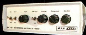
Récepteur 6.900 à 7.350 MHz avec BFO, pour permettre la réception des signaux CW, BLU. Alimentation 12 Volts 150 mA, sur piles ou alimentation externe. Description complète dans la revue Nouvelle Electronique n°47.
