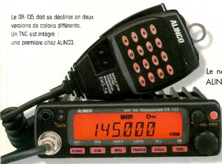
Le nouveau DR-135 du fabricant ALINCO est un transceiver mobile VHF doté d'un TNC permettant le trafic Packet et APRS. Il est capable de délivrer une puissance de 50 watts entre 144 et 146 MHz. Le TNC fonctionne à 1 200 ou à 9 600 bauds et une entrée GPS est prévue en façade
