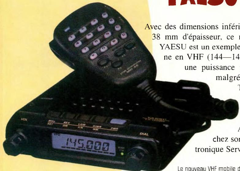
Avec des dimensions inférieures à 130 mm de côté et 38 mm d'épaisseur, ce nouveau transceiver mobile YAESU est un exemple de compacité ! Il fonctionne en VHF (144—146 MHz), en FM, et délivre une puissance pouvant atteindre 50 watts malgré ses faibles dimensions. Taille réduite oblige, certaines commandes sont disposées sur le dessus du boîtier, près de la façade. A découvrir prochainement chez son distributeur Générale Électronique Services.
