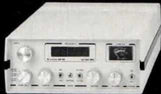
Affichage sur 5 digits, bande passante commutable 30 KHz ou 150 KHz, sensibilité d'environ  $0,8 \mu V$ , vumètre pour sensibilité de réception. Description complète dans la revue Nouvelle Electronique n°38.
