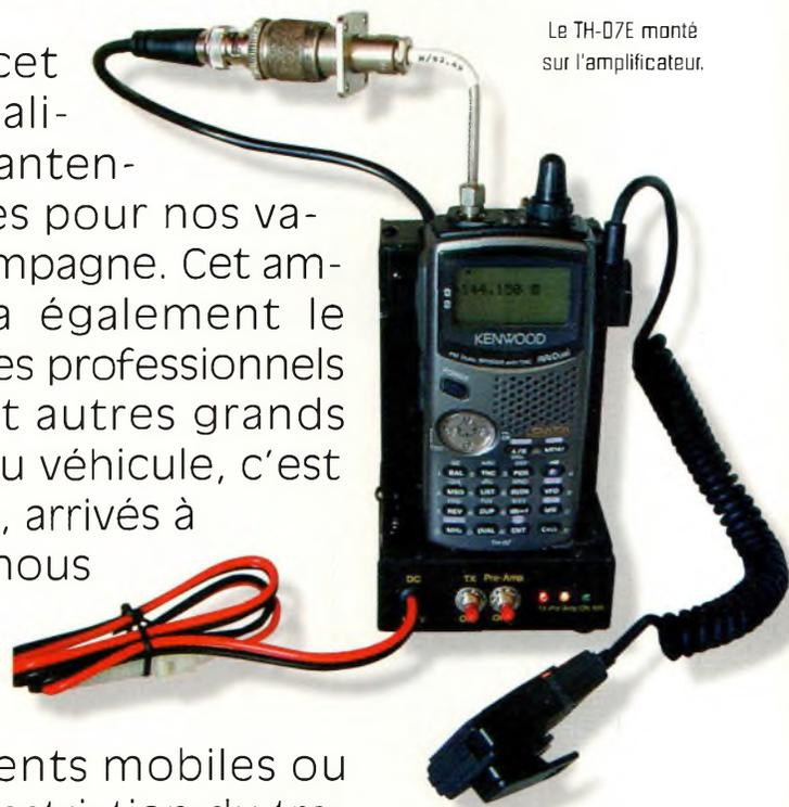
Le TH-D7E monté sur l'amplificateur.
