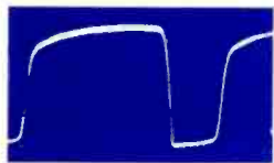
4. GRID, HORIZ. OUTPUT, V6, "AB", 335V P-P HORIZ. (PWS2)
