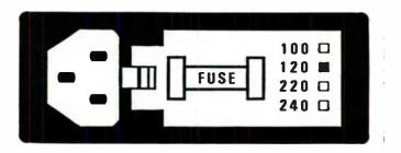
FIGURE 2-3 LINE VOLTAGE SELECTION
