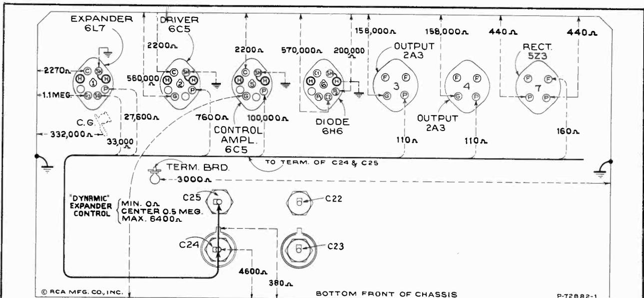
Figure 5—Resistance Diagram
