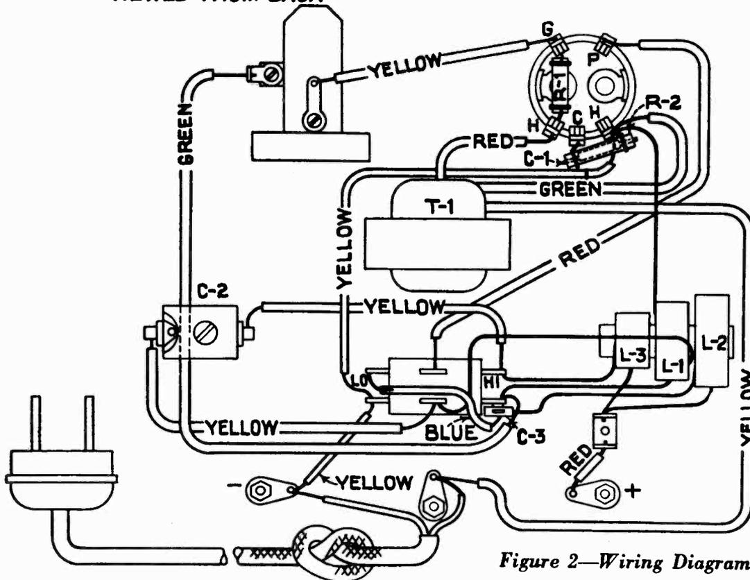
Figure 2—Wiring Diagram
