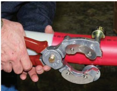
Longitudinal Jacket Cut
