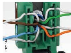
Posizione del cavo centrale per un'apertura delle coppie fino a 7 mm.
