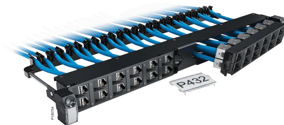
Il pannello piatto presenta una configurazione frontale per 24 prese RJ45 chiaramente identificate sia sul fronte che sul retro. I pannelli sono semplici da installare grazie all'accessibilità frontale e alla funzione Quick Fix. Utilizzate gli appositi anelli passacavi verticali per l'organizzazione delle patch cord. Altri vantaggi importanti sono l'organizzatore cavi removibile, il sistema di identificazione chiara con etichette e l'ampio portaetichette centrale.
