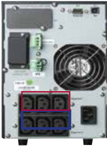
Eaton 9130 UPS iki yük bölümüne sahiptir. Her birinde üç IEC320-C13 vardır.
