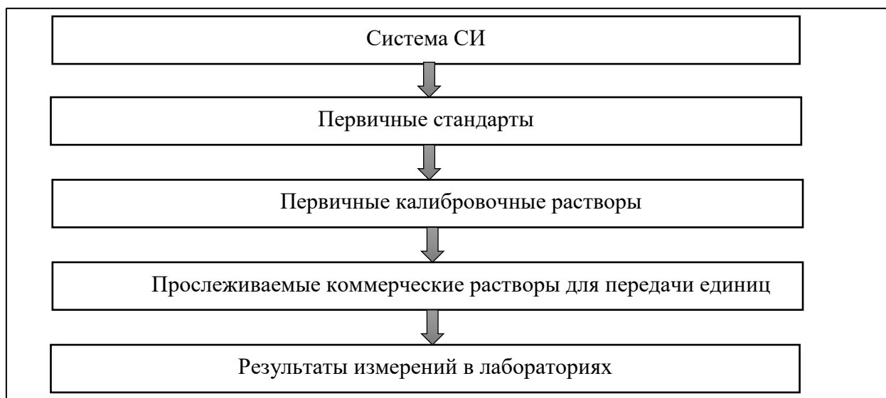
Рисунок 6 – Схема прослеживаемости результатов измерений к единицам СИ (BAM, Германия)
