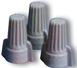
GREY 18-8 AWG WIRE RANGE: max: 3 #10 min: 3 #14 w/1 #18 VOLTAGE: 600 volt max**
