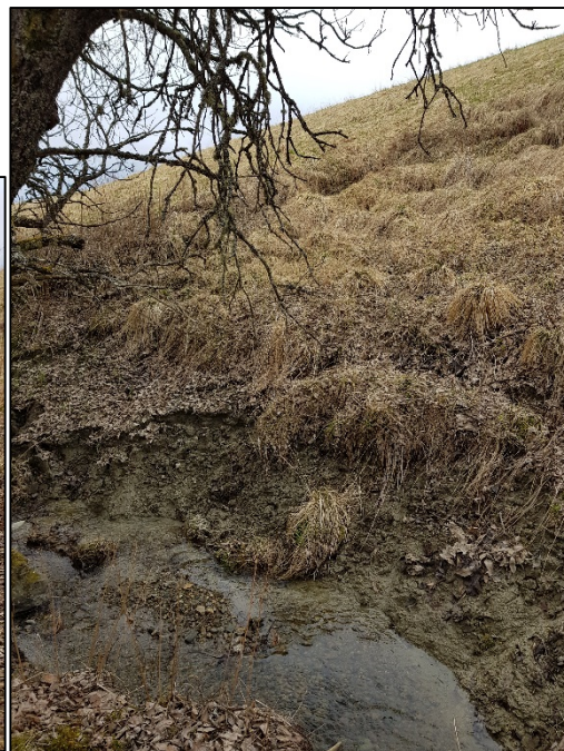
Bilde 6 og 7 - Tegn til en større utglidning/bevegelse og erosjon i bekkedalen med blottlagt leire i bekken
