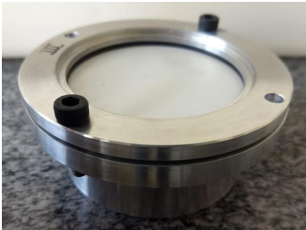
Figure S 1. Dispositivo diseñado para el ensayo de la tasa de transmisión de vapor de agua.
