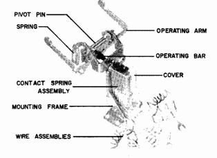
Fig. 2-1 TYPICAL CRADLE SWITCH
