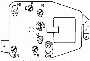
Fig. 3-1 TERMINAL BOARD LAYOUT
