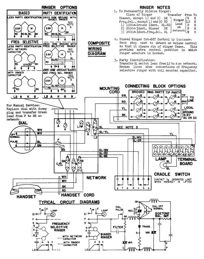
Fig. 2 DIAGRAMS 500--(--)31- TELEPHONE
