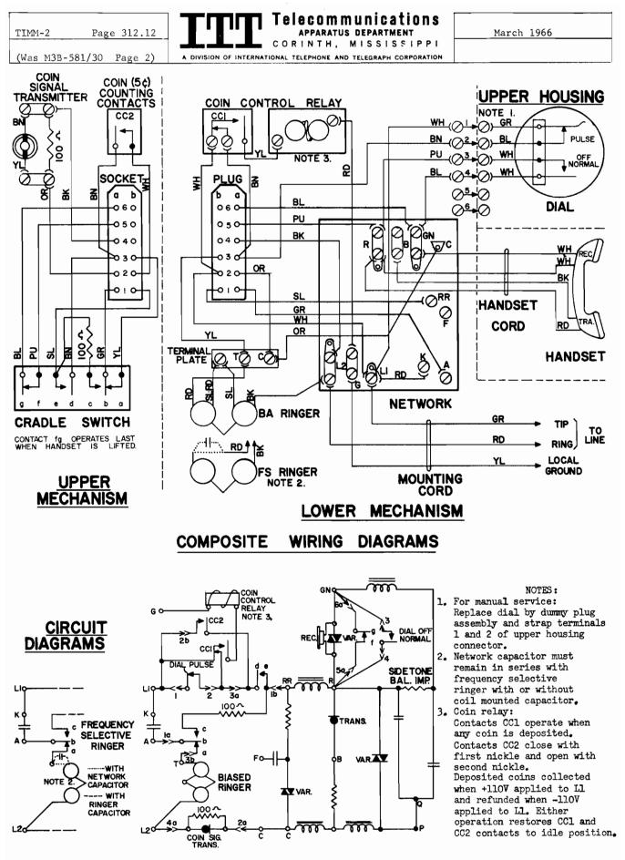
Fig. 2 DIAGRAMS 581--(--)30- TELEPHONE
