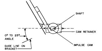
Fig. 2 POSITION OF PULSING CAM
