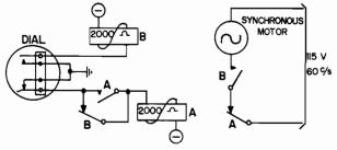
Fig. 2-2 SIMPLE DIAL SPEED TESTER
