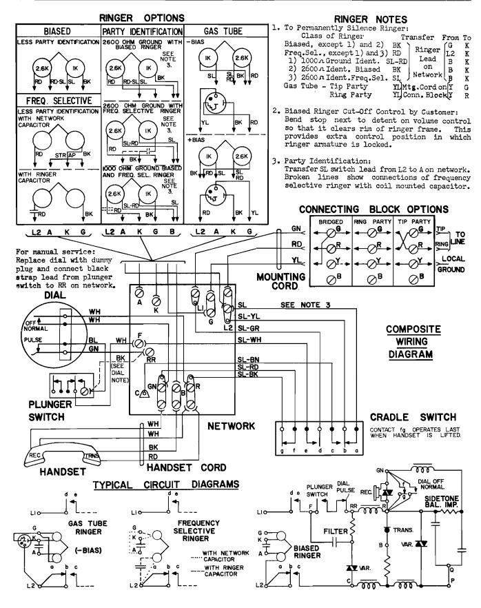
Fig. 2 DIAGRAMS 500--(--)33- TELEPHONE
