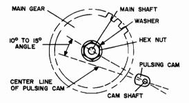
Fig. 2 POSITION OF PULSING CAM
