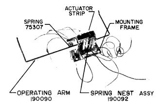
Fig. 2-1 TYPICAL CRADLE SWITCH
