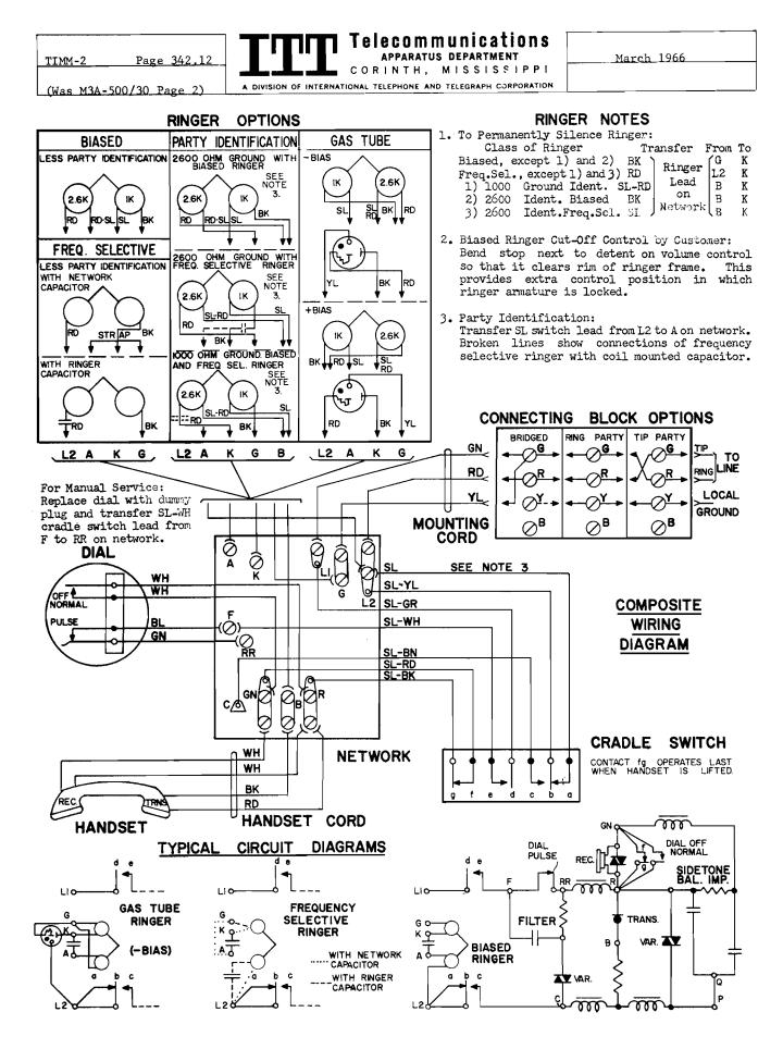
Fig. 2 DIAGRAMS 500--(--)30- TELEPHONE
