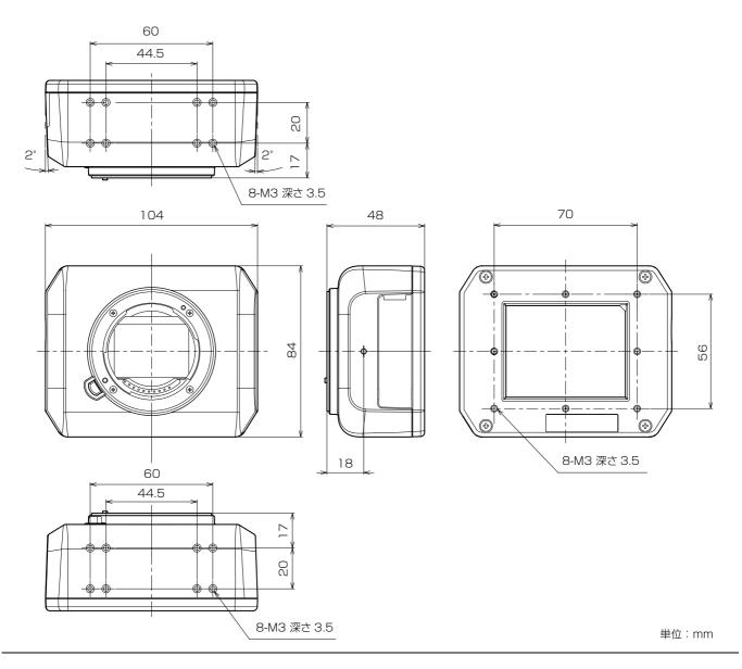
三脚アダプターを取り付けたときの外形寸法(直径×高さ) [記載の外形寸法は、おおよその数値です。]
