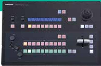
Le centre de production en direct associe des fonctions de mélangeur 1ME, de contrôleur de caméra PTZ et de mélangeur audio pour permettre à une seule personne de facilement réaliser des streaming en direct.
