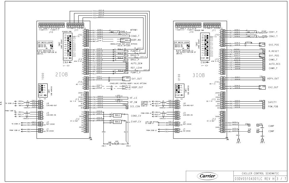
Fig. 24 — IOB2 and IOB3
