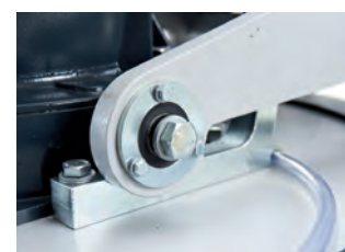
ADS: Suspension antichoc de l'engrenage
