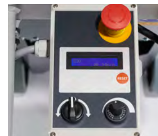
Affichage avec affichage de la puissance et compteur d'heures de fonctionnement
