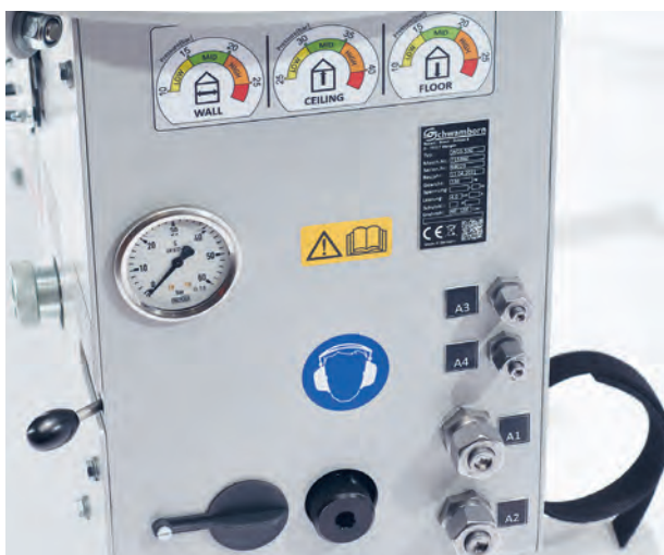
Réglage de la pression d'appui et des raccords hydrauliques
