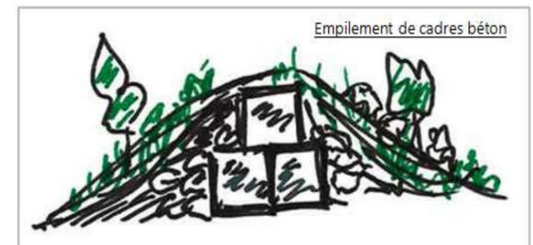
**Planche 126 : Schémas de principe d'abris à chauves-souris**
