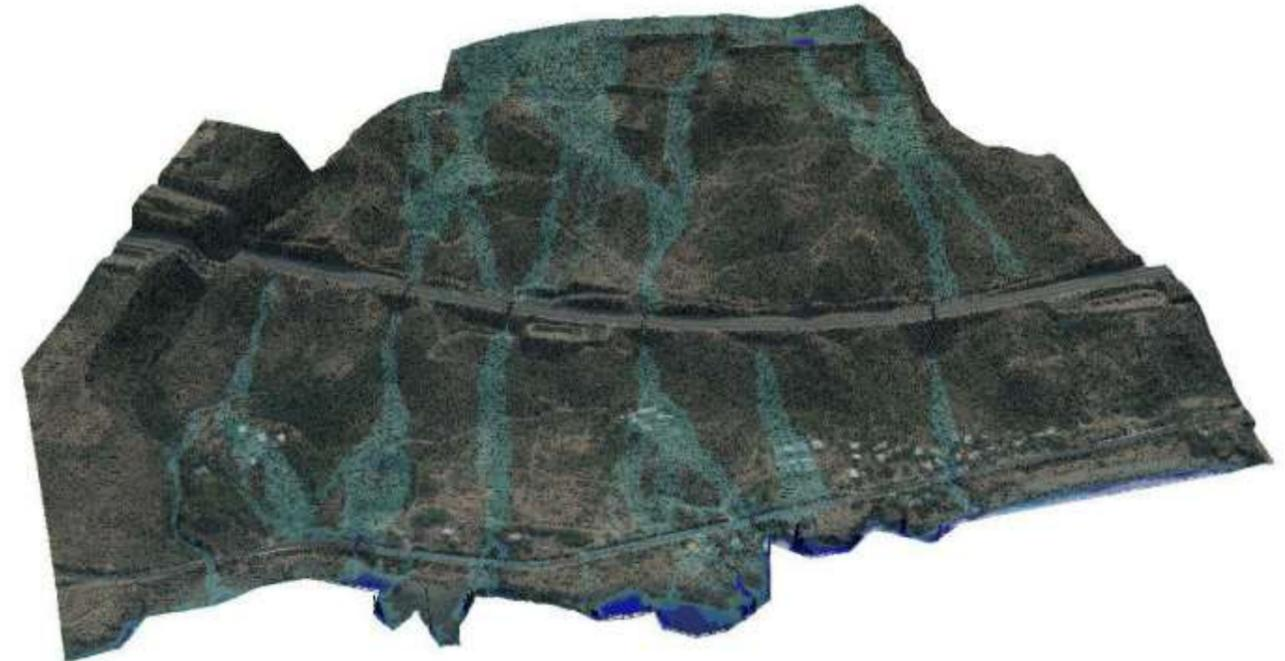
Planche 108 : Représentation 3D des écoulements du scénario 1 – Crue centennale en l'état initial
