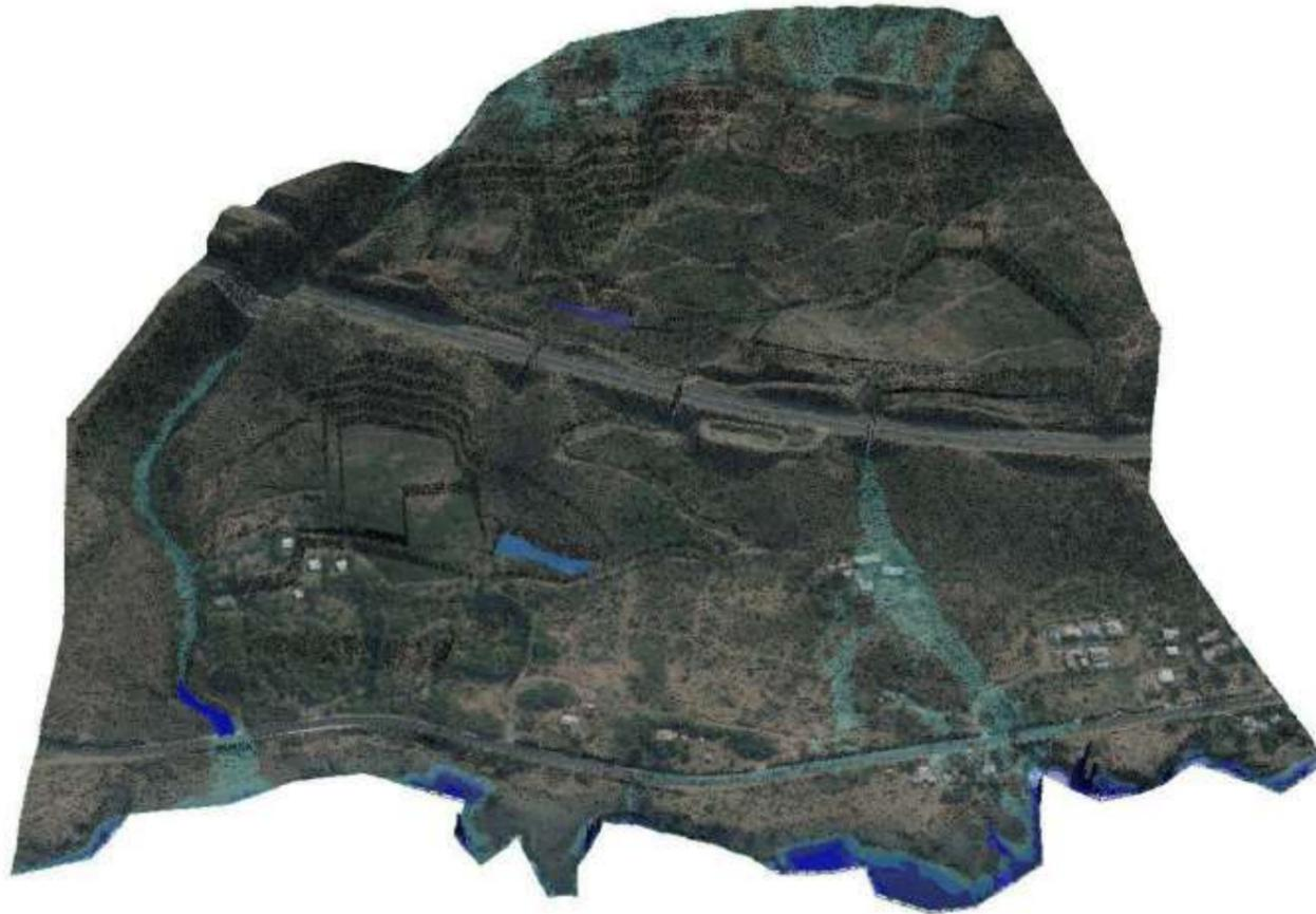
**Planche 110 : Représentation 3D des écoulements du scénario 2 – Crue décennale en phase d'exploitation**
