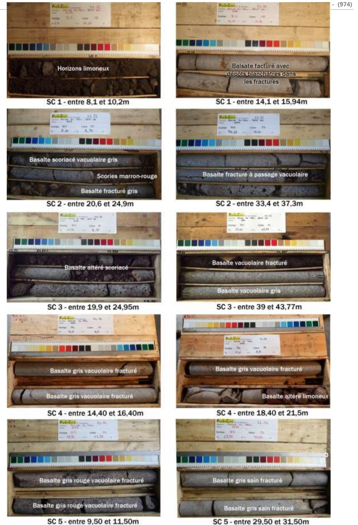
**Planche 45 : Exemples d'horizons présents dans les sondages carottés (extrait du rapport de sondage Forintech fourni en Annexe 4)**
