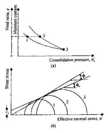
Figure 7.46 Determination of  $C_{\rm e}$  and  $\phi_{\rm e}$ .
