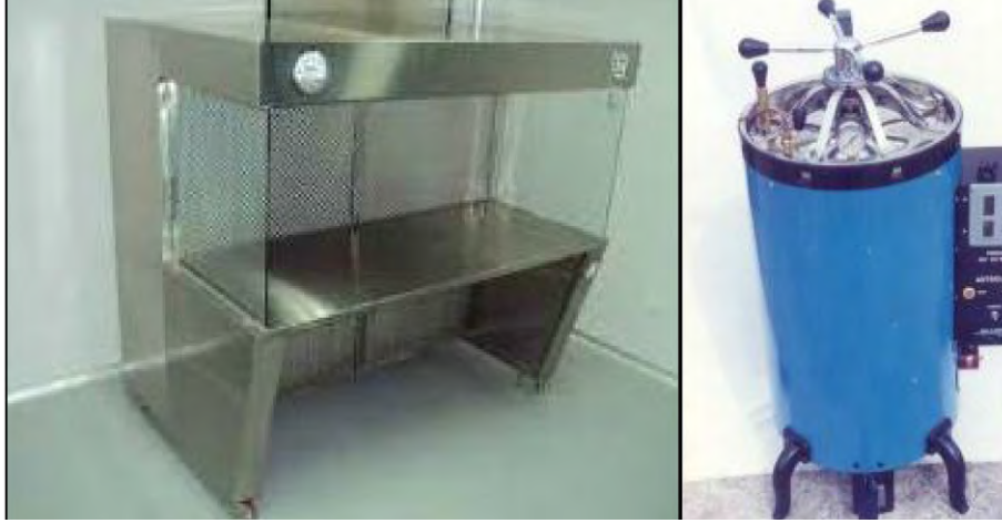
आकृती क्र.३.५ प्रयोगशाळेतील उपकरणे (लॅमिनार एअर फ्लो, आटोक्लेव्ह)
