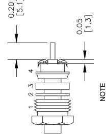
INSERT PTFE BEFORE CONTACT. WITH LARGE OPEN END SLIDING OVER CENTER CONDUCTOR & DIELECTRIC
