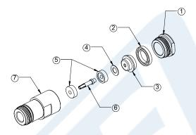
SLIDE CLAMP NUT (1), GASKET (2) AND WASHER (3) OVER CABLE. STRIP CABLE AS SHOWN. DO NOT NICK BRAID WHILE CUTTING JACKET. TAPER END OF BRAID TO PERMIT ASSEMBLY OF CLAMP.
