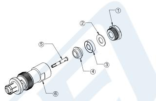
1. SLIDE CLAMP NUT (1), WASHER (2) & GASKET (3) OVER CABLE. STRIP CABLE AS SHOWN. DO NOT NICK BRAID WHILE CUTTING JACKET. TAPER END OF BRAID TO PERMIT ASSEMBLY OF CLAMP.
