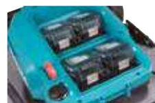
Slot 4 batterie (DLM533 / DLM532 / DLM530 / DLM462)
