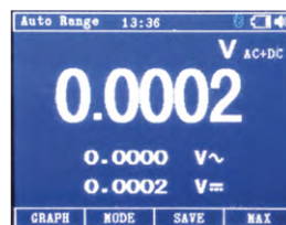
zobrazení AC a DC složky napětí
