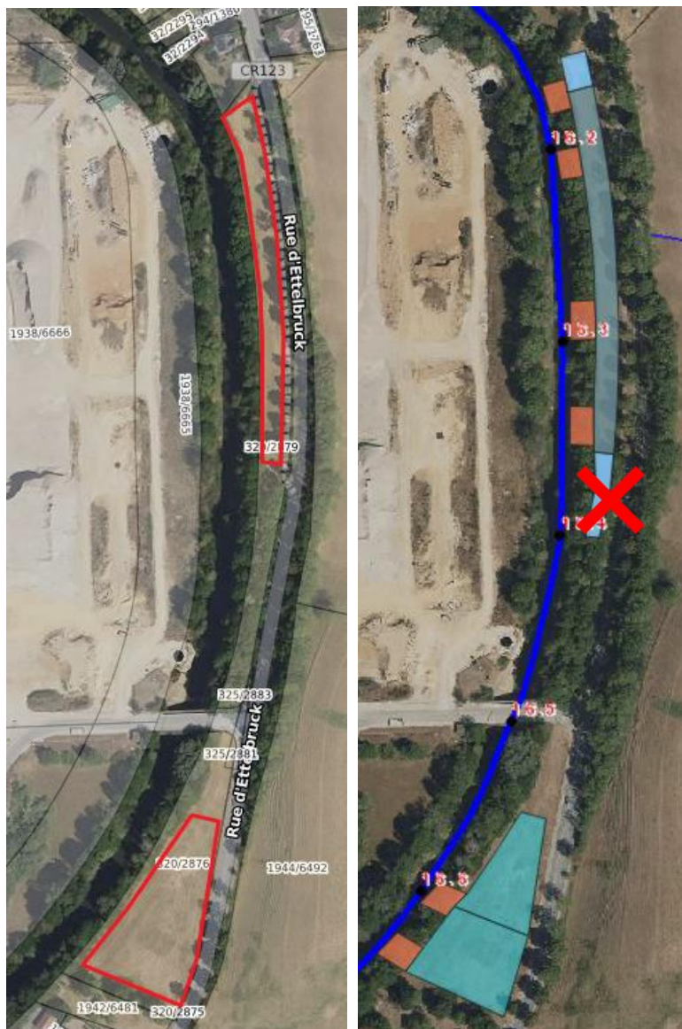
Abb. 12: Darstellung der möglichen Flächen zur gemeinsamen Kompensation des HQ100-Retentionsvolumens für die hier betrachtete Prüffläche Site 08 und den PAP Quartier de l'Alzette. Links: Abgrenzung der Katasterparzellen 320/2876 und 320/2879. Rechts: Markierung der Kompensationsflächen (blau) und des Ein- /Auslaufs (braun) (Quelle: Schroeder Associés 2023). Vollständige Variantenprüfung in Anhang 08.
