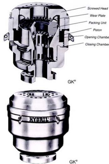
Figure D.2. Exemplar: Hydril Annular BOP
