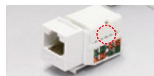
キャップは、側面下側の中央部分に爪を引っ掛けて持ち上げると、簡単に外れます。
