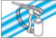
スタッドボルトにタイを固定して使用します。結束後の取り外しができ、再結束が可能です。
