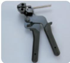
メタルタイの締め付けと切断を行う工具です。トリガーを繰り返し引くことで、締め付け力を調整し、最後にタイカット用レバーを押し上げて、余分なタイを切断します。取り扱いが簡単で、手で締め付けるよりも確実な結束が行えます。
