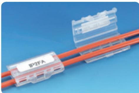
φ3mmの2心光コード用です。光コードを挟み込み、ワンタッチで取り付けができます。2段階操作で、コードを傷める危険性が低くなります。第1段階(仮止め状態)でケーブルに沿ってIP2FAを移動させ、第2段階(本止め)で適正な位置に固定します。また、装着後も再利用が可能です。表裏の面に、手書きでコードの行き先を書き込んだり、TABTAGラベル(TAGN1L-9372※P122)をお使いいただき、ラベルを貼っていただくことも可能です。
