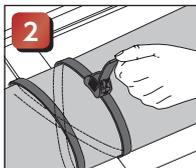
結束タイの先端をMK15のタイ挿入口の溝(凹み)に横から差し込みます。
