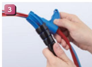
専用工具 HAT の突起部を、ヘララップの一方の端の中へ通すようにヘララップを被せていき、配線に直接被さるまでスライドさせます。
