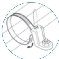
スタッドボルトタイSBTタイプは、ナットを外さずに、結束物の取り外しができます。また、結束径を調整できるため、幅広い径の配線に対応できます。66ナイロン製で、絶縁性に優れ、電線の被覆を傷つけません。
