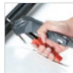
専用工具で、ストラップを目打ち(パンチ)し、ヘッド部に設けられた穴にかしめるため、耐振動性の高い強固な結束を実現します。
