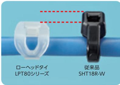
結束バンドの中で、最も低く、丸みのあるヘッド部デザインのため、複数のハーネス束を組み合わせたワイヤーハーネスでも、ヘッド部の出っ張りが邪魔になりません。ワイヤーハーネス全体の径をコンパクトにし、筐体(シャーシ)への組み込み作業中の引っ掛かりや、周辺への干渉などを防止するだけでなく、電線被覆を傷つけない、安全性に配慮した製品です。
