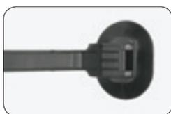
楕円穴固定用のプッシュマウントタイです。通常の丸穴固定用タイプと異なり、パネル挿入後のワイヤーハーネスの回転を防ぐことができます。そのため配線方向の位置を固定することができ、ワイヤーハーネスの損傷防止に役立ちます。
