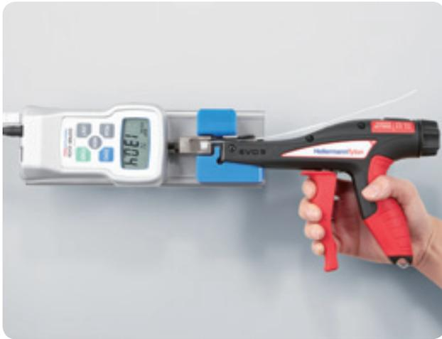
タイムイト専用の締め付け力管理用テスターです。現在ご使用中のヘラマンタイトン製手動結束工具の締め付け力を測定することができ、日常の校正管理、修理依頼への目安としてご利用いただけます。手動工具の締め付け力の校正履歴を管理することで、より安定した高品質の結束作業が継続できます。
