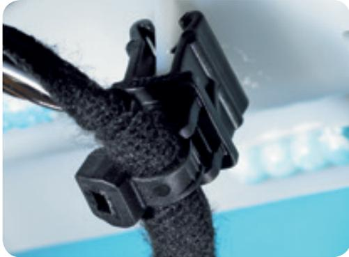
プラスチックや金属製のパネルエッジにはめ込み、インシュロックタイと併用して配線を結束・固定します。パネルエッジへ強固に取り付けることが可能なメタルクランプ機構を採用しているため、高い引き抜き強度で、ガッチリと配線を固定します。ビス止めが不要なため、パネルへの穴あけをする必要がありません。配線の結束・固定・緩衝の3つの機能を持ち、部品点数の削減に貢献します。
