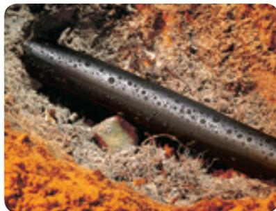
厚肉タイプの熱溶融接着剤付きチューブで、低中電圧での絶縁にご利用いただけます。高い耐久性と耐環境性、防水・防塵性に優れ、地下埋設や屋外での使用にも適しています。収縮比が、3:1~4:1と高く、一つのサイズで幅広い径に対応します。※非難燃性です。
