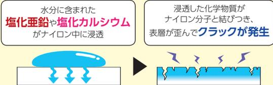
66ナイロン製結束バンドの破断は、塩害の影響による溶剤クラックと紫外線による耐候性劣化からの破断の2種類があります。
