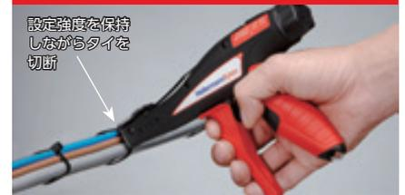
繰り返しトリガーを引くと、設定した締め付け力に達し、タイを切断するまで設定した締め付け力を保持し続けます。そのため、タイに必要な以上の締め付け力が掛からず、安定した締め付け力で連続作業が行えます。
