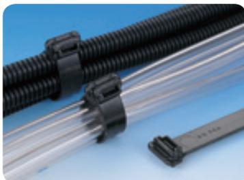
高いループ引張強度を持ち、太径ケーブルやチューブの結束に適しています。ヘッド部はコンパクトなデザインのため、限られたスペースでもご使用いただけます。また、ヘッド部裏面にはクランプレールが設けられ、柔らかいホースやコルゲートチューブを結束しても、噛み込みを最小限に抑えることが可能です。肉薄のストラップのため、柔軟性に富み、被結束物への負担を減らします。
