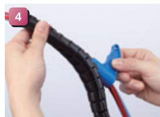
配線に被せたヘララップの片端をつかんで固定し、専用工具 HAT を配線に沿ってスライドさせるとヘララップを装着できます。
