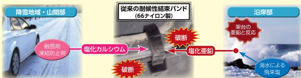
亜鉛めっき鋼板の亜鉛と海水に含まれる塩分が反応すると塩化亜鉛が発生し、短期間で 66 ナイロン製結束バンドを劣化・破断させます。降雪地帯や山間部で散布される融雪剤・凍結防止剤の主成分である塩化カルシウムも 66 ナイロン製結束バンドを劣化・破断させる原因です。
