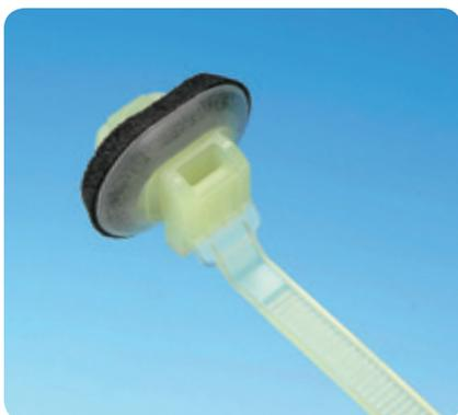
楕円穴用のタイプは、パネル挿入後のハーネスの回転を防ぐことができるため、配線方向の位置を固定し、ワイヤーハーネスの損傷を防止することが可能です。
