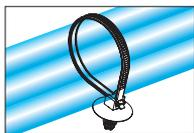
広い範囲の板厚に対応するファーツリーマウント形状のため、部品点数の削減に貢献します。パネル穴へ差し込み、固定する際、配線を取付穴の真上で固定できるオンセットタイプです。アウトサイドセレーションのため、被覆の柔らかい電線結末に適しています。
