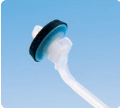
CRスポンジゴム製防水パッキン付きで、取付穴に固定した後に、パネル裏側への水や汚れの侵入を防ぎます。防水パッキンはレーザー溶着されており、外れることはありません。ワイヤーハーネスを取付穴の真上で結束固定できるオンセットタイプです。
