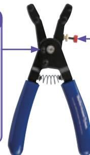
開き量調節ネジと締め付け量調節ネジをご使用になるスナッパーに合うように調整し、右のようにスナッパー上部を挟み込むようにご使用ください。
