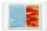
注入前のレジンは二色に分かれており、薄青色のレジンがオレンジ色の硬化剤と混ざることによって緑色に変化し、目視でしっかりと混ぜ合わさったことが確認できるため、混合不足による硬化不良を防止します。
