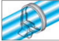
ウイング(支持翼)付きタイプのプッシュマウントタイのオンセットタイプです。パネル穴へ差し込んで固定する際、配線を取付穴の真上で固定できます。また、結束後セレーションが外側に出るアウトサイドセレーションのため、被覆の柔らかい電線結束に適しています。
