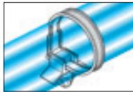
矢じりが大きく、厚板に固定できるため、トラックなど、大型車両のシャーシフレームのワイヤーハーネス固定に最適です。
