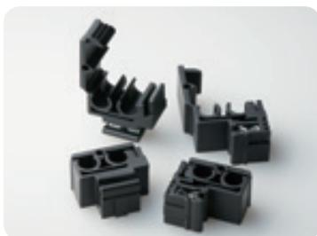
ソーラーパネルや架台フレームのエッジにはめ込み、ケーブルを挟むだけで簡単に配線施工できる、作業性抜群の配線固定具です。横ズレ防止機能付きロック機構のカバーで、ケーブルのズレや外れを防止します。
