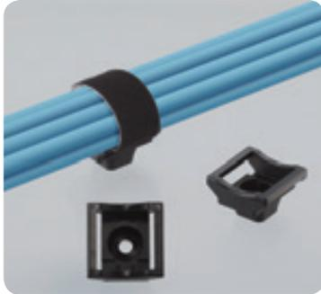
グリップタイマウントベースは、グリップタイ(P74~76)と併用してケーブルを固定することができます。配線固定具です。ラックなどの穴に、M5サイズのビスでしっかりと取り付けることができます。また、ビス穴の座面が小さく、高さがあるため、通信ラックやテツガ(鉄架)上の狭いスペースでも取り付けることが可能です。面ファスナー式のグリップタイ\*で結束するため、繰り返し使用できるほか、ケーブルの被覆を傷つけません。
