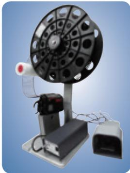
連続作業用です。フットペダルで操作を行うため、両手を使って結束作業ができます。
