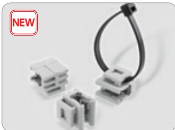
山形鋼、リップ溝形鋼などの建築鋼材やケーブルラック、電路支持材のアンクル、チャンネルなどのエッジにはめ込み、簡単に配線を結束・固定することができます。インシュロックタイを併用するため、1本~複数本のケーブルのほか、PF管なども固定することが可能です。独自のハウジング形状と爪クランプ機構を採用し、鋼材のエッジにガッチリと食い込み、強固に固定します。ナイロン製のハウジングのため絶縁性に優れ、穴あけ・ビス止めも不要で作業効率がアップします。
