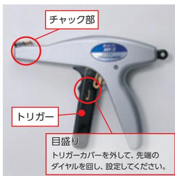
トリガーを引くことで、インシュロックタイの締め付けと切断を順次行います。その際、締め付けられたタイに必要な締め付け力を与えず、切断する機構です。独自のメカニズムを採用しているため、常に安定した締め付け力が得られます。インシュロックタイの細幅タイプ(幅1.8mm~3.6mm)を確実に締め付けるのに有効です。
