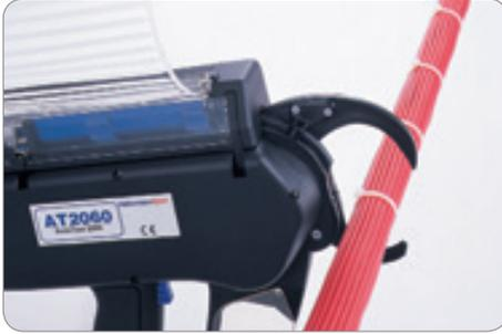
ヘラマンタイトンの全自動結束システムは、ボタン一つで、インシュロックタイの供給、締め付け、切断という工程をわずか1秒程度で行うことができ、結束作業の省力化に大きく貢献します。
