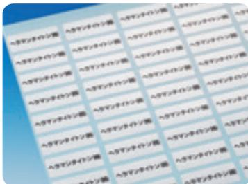
封筒の封入口などに貼り付けて使用します。一度貼り付けたラベルを剥がすと、ラベルフィルムの特加工により基材または被着体に「開封済」の文字が現れるため、開封の有無を瞬時に判別することができます。
