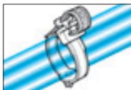
結束前にピンを打ち込み、タイ自体をシャシ、パネルなどに簡単に固定できます。結束後の取り外しができ、再結束が可能です。
