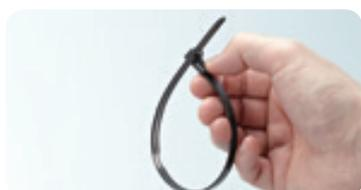
植物由来原料100%の環境対応型製品です(ASTM 6866試験では97%以上の含有量となります)。11ナイロンは66ナイロンと比較し、耐熱性が高く、低吸水性に優れています。耐候性、塩化カルシウムや、塩化亜鉛への耐性に優れ、高機能樹脂としてご採用いただいております。
