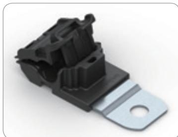
ラチェットPクランプは配線の取り付け、取り外しが容易な、作業性に優れた配線固定具です。1ピースデザインで、ワンタッチで配線を取り付けることができます。取り付け後もクランプ部のロックを簡単に解除できるため、作業性に優れています。一般的なP型クリップとは異なり、配線の取り付けや固定位置の調整が簡単です。また、1サイズで様々な結束径に対応可能なため、部品点数の削減に貢献します。クランプ部が樹脂製のため、金属クリップのようにケーブル被覆などを傷つけることがありません。
