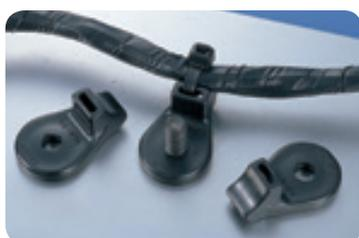
建設機械、重機、自動車などのスタッドボルトに取り付けて固定し、インシュロックタイを使用することで、油圧ホースや電線を強力に保持することが可能です。金属製のクリップや針金をスポット溶接する方法に比べ、大幅に美観が向上します。
