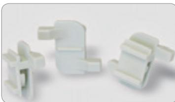
金属製チャンネル用マウントはインシュロックタイを併用してPF管を固定し、呼び径16、22、28の幅広いPF管に対応します。金属製チャンネルには90度回すだけで簡単に取り付けることができ、位置移動も容易です。ズレ防止のリップが付いているので、PF管をしっかり固定します。
