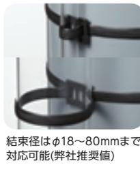
電柱と電線、電線管、モールなどの間に挟み、エンドレスタイで配線固定し、隙間をなくして、確実に固定できます。電柱と電線の共締め結束が原因の「浮き」や「ズレ」といった施工不良を防止し、緩衝材として被覆を傷から守ります。耐候性ポリアセタール樹脂製で絶縁性に優れ、長期間の屋外環境下での使用に耐えます。
