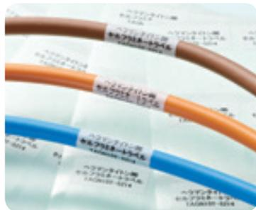
汚れや溶剤に強いセルフラミネートラベルは、印字部を透明ラミネートで覆うため、印字部が保護されます。柔軟性に優れ、ケーブルやチューブに巻きやすく、湾曲したケーブルにも安定した接着力を維持できます。また、防湿性、耐油性・耐薬品性にも優れています。
