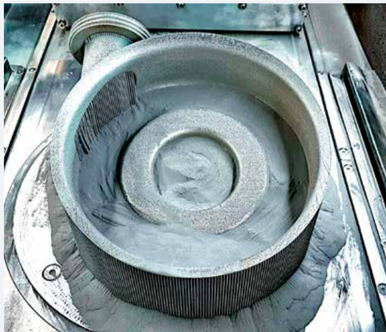
Корпус насоса, напечатанный «2050.AT» из нержавеющей стали марки 316L
