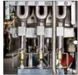
Particolare bruciatori inox a gas ad alto rendimento. Detail of high performance stainless steel gas burners. Détail des brûleurs en acier inox à gaz à rendement élevé. Besondere rostfreie Gasbrenner mit Hochleistung
