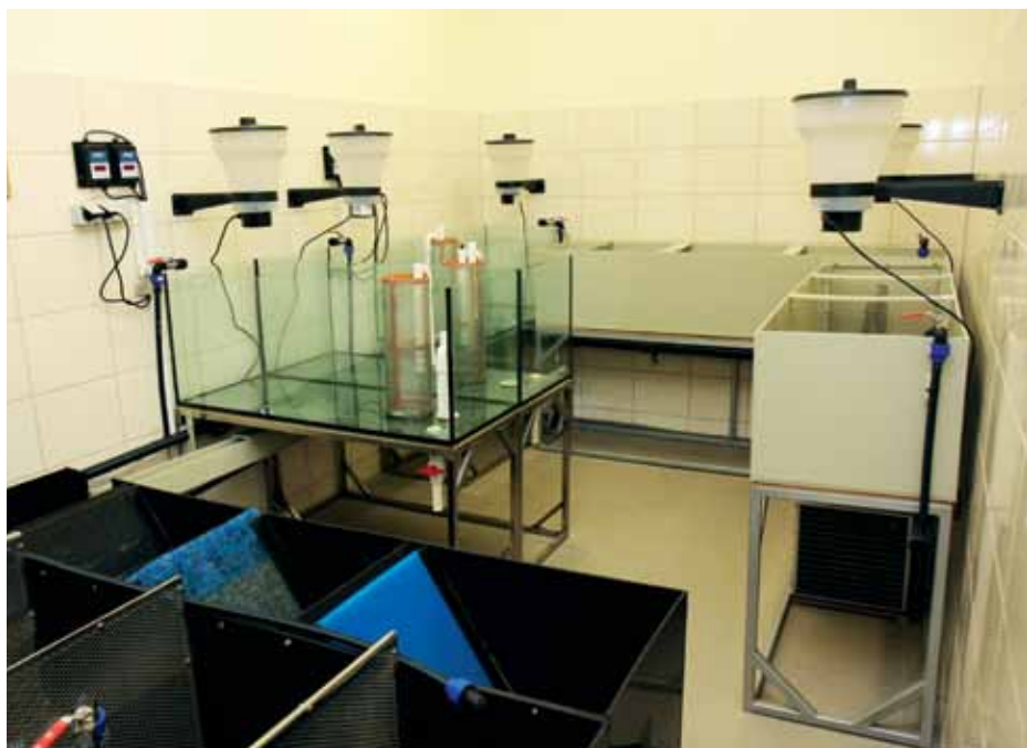
Pētnieciskā recirkulācijas siltūdens zivju audzēšanas sistēma
