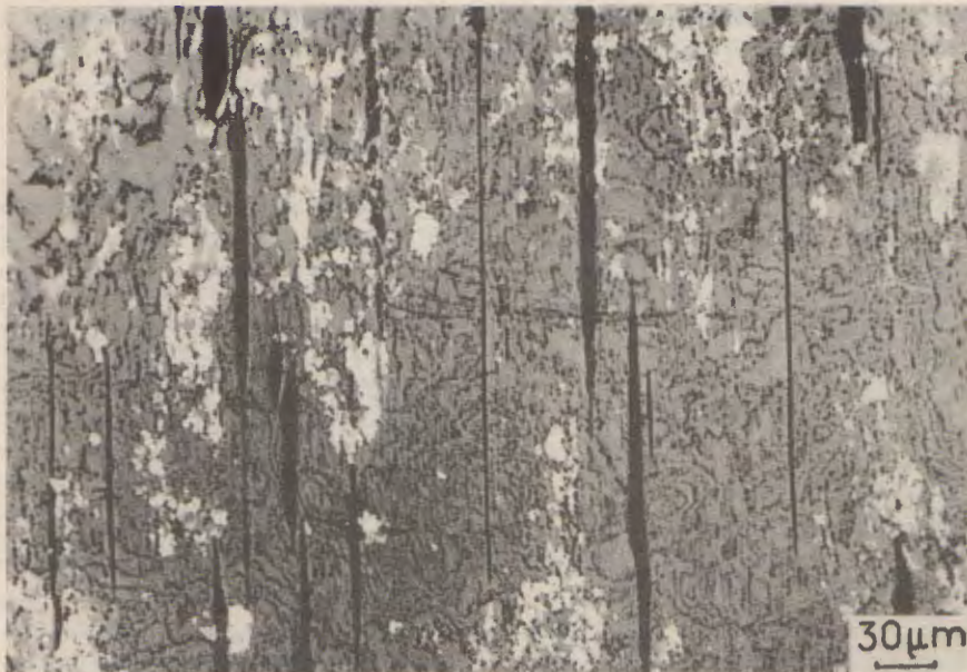
FIG. 5 : Micrographie. Microfissures se formant dans une tôle de titane au cours d'un essai de corrosion sous contrainte à 400 °C.
