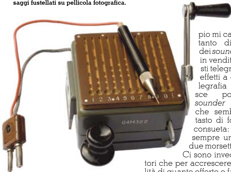
Fig. 1 - Dispositivo utilizzato dagli agenti sovietici durante la Guerra Fredda. Integra una tavoletta per trasmettere in Morse con l'ausilio di uno stilo, un tasto tradizionale e un encoder a manovella per la trasmissione burst di messaggi fustellati su pellicola fotografica.
