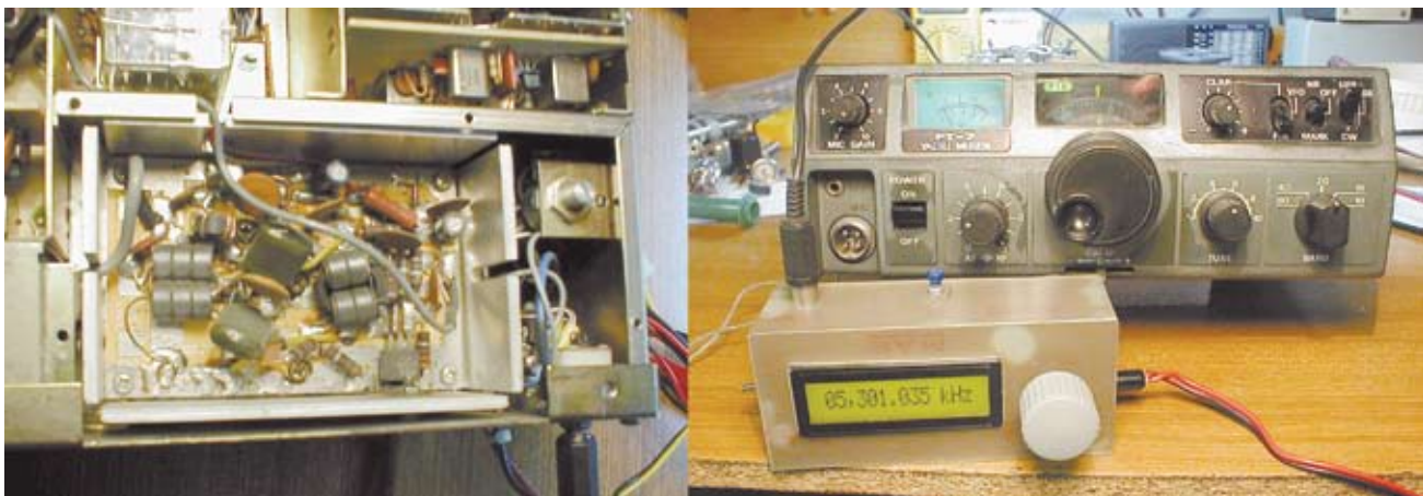
Foto 6 - Il modulo del finale e le prove con un DDS di Pino quale VFO esterno
