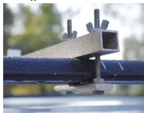
Foto 1 - Realizzazione delle barre trasversali: fissaggio.
