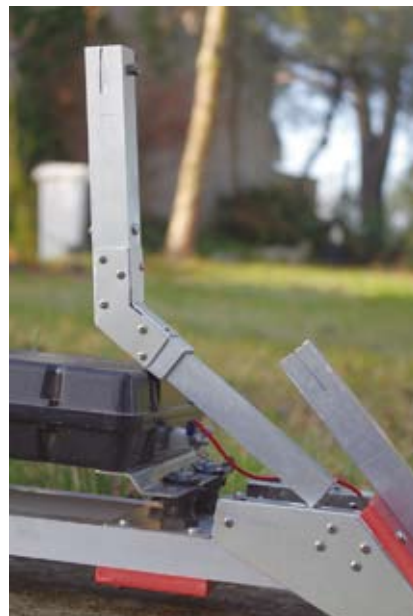
Foto 5 - Adattatore per il montaggio dell'antenna in verticale.
