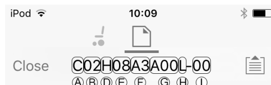
Fig. 7-1 Exemple de nom de programme standard. Les légendes et les zones marquées correspondent aux règles de nommage du programme.
