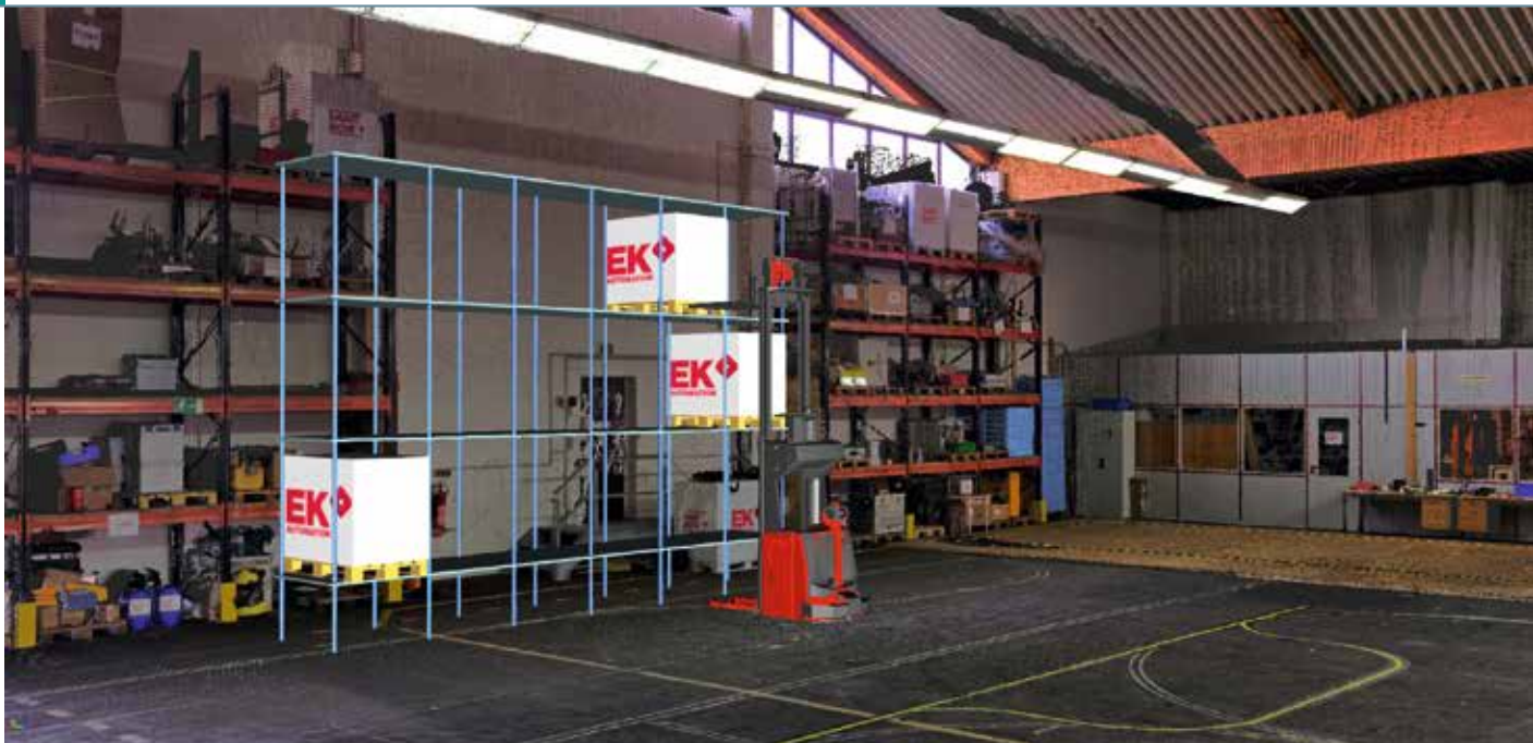
Die Punktwolke, angefertigt mittels 3D-Laservermessung, liefert exakte Daten für die Erstellung eines Simulationsmodells in den vorgegebenen Räumlichkeiten
