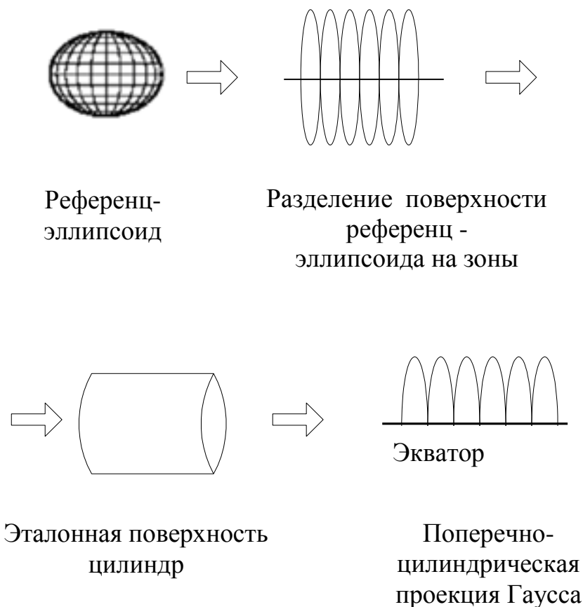
Рис. 8.2. Построение поперечно-цилиндрической проекции Гаусса
