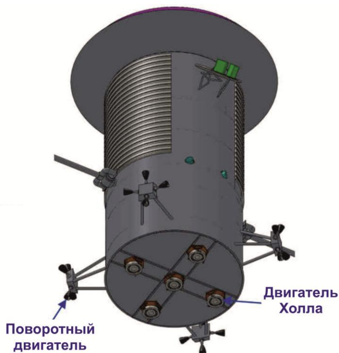
Рисунок 7.6 - На виде снизу показаны пять двигателей Холла мощностью по 10кВт и поворотные двигатели
