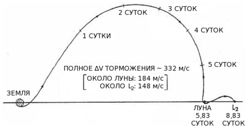
Рисунок 5.2 - Непрямой переход с низкой околоземной орбиты к точке L2 системы Земля-Луна [8,10]. Система координат аналогична рис. 5.1
