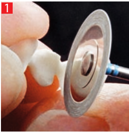
1 Bearbeitung von gehiptem Zirkondioxid. Trimming of sintered zirconia. Façonnage d'oxyde de zircon du type HIP.
