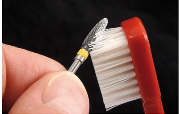
Reinigung bei leichten Verschmutzungen mit einer Zahnbürste. For cleaning slightly contaminated surfaces use a dental brush. En cas de crasse, nettoyage avec une brosse à dents.
