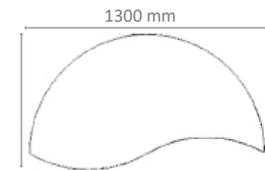
Plateau en MDF de 22mm, blanc avec finition en PVC de 1,5mm et chants arrondis. Structure tubulaire métallique, peinture époxy
