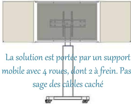
La solution est portée par un support mobile avec 4 roues, dont 2 à frein. Passage des câbles caché
