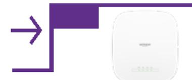
Point d'accès WiFi 6 Dual Band (2x2), délivrant un débit WiFi jusqu'à 3Gbit/s. Doté d'un port Ethernet PoE Multi-Gigabit à 2.5Gbit/s
