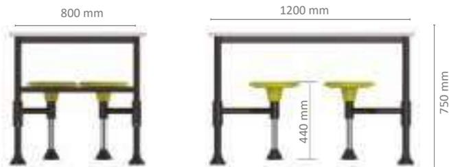
Plateau composé d'un panneau de particules d'une épaisseur de 18 mm, avec une surface mélaminée blanche. Chants en PVC injecté, vert pomme. Bords arrondis, pour plus de sécurité
