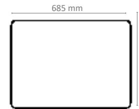
Plateau en MDF, 22mm, blanc, avec finition PVC de 1,5mm et chants arrondis. Structure tubulaire en aluminium. Patin plastique pour niveler la hauteur de la table
