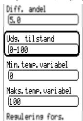
Alt efter pumpetype kan dens styremodus være normal (0-100, "solvarmemodus", PWM 2) eller invers (100-0 "centralvarmemodus", PWM 1). Tillige kan pumpen kræve bestemte grænser for styringsområdet. Disse oplysninger indhentes hos pumpens producent.
