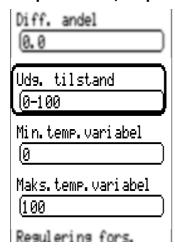
Alt efter pumpemodel kan pumpens styringsmodus være "normal" (0 – 100, "solvarmemodus", PWM2/PWM-C) eller invers (100 – 0, "varmeanlægs-modus" PWM1/PWM-A). Ligeledes kan der være krav til begrænsninger i styringsområdet. Disse angivelser stilles til rådighed af pumpeproducenten.
