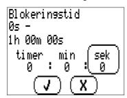
Når en udgang slukkes af styringsautomatikken, tændes den ikke igen før udløbet af den indstillede blokeringstid.
