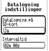
Indstillinger for datalogning: **Datalogning på SD-kort** igangsætter logning af forindstillede data på styringens mikro-SD-kort. Intervaltiden bestemmer datalogningens hyppighed. Yderligere informationer, se under **datalogning**. Bemærk specielt henvisningerne vedrørende sammenhængen mellem intervaltid og SD-kortets levetid.
