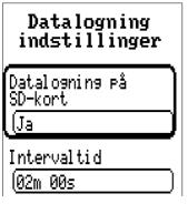
Indstillinger for datalogning: **Datalogning på SD-kort** aktiverer logning af de indstillede data på det isatte Micro-SD-kort. Intervaltiden bestemmer hvor tit der skal gemmes data. Du finder mere om dette under punktet **Datalogning.** Dette punkt skal ubetinget studeres, frem for alt med hensyn til sammenhængen mellem intervaltid og SD-kortets levetid.
