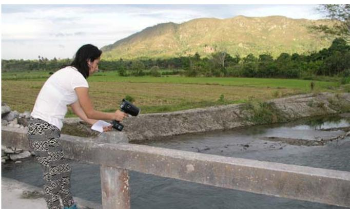
Fig. 51. Mesures du débit du Rio Negro au pistolet radar.
