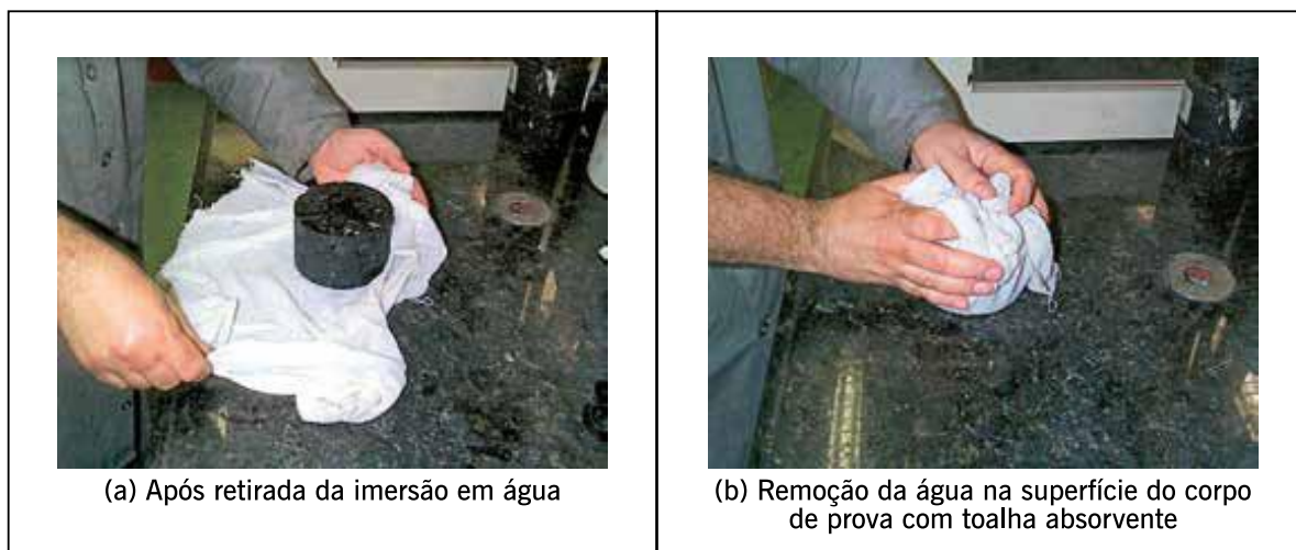
Figura 5.4 – Obtenção da condição de superfície saturada seca em corpo de prova de mistura asfáltica compactada
