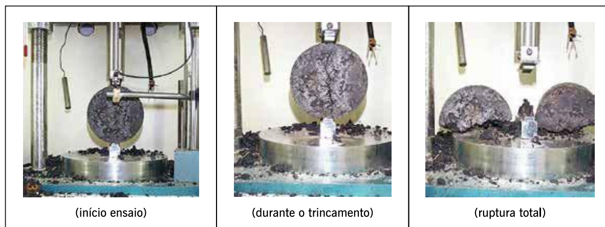
Figura 6.23 – Fases do ensaio de fadiga por compressão diametral de CA
