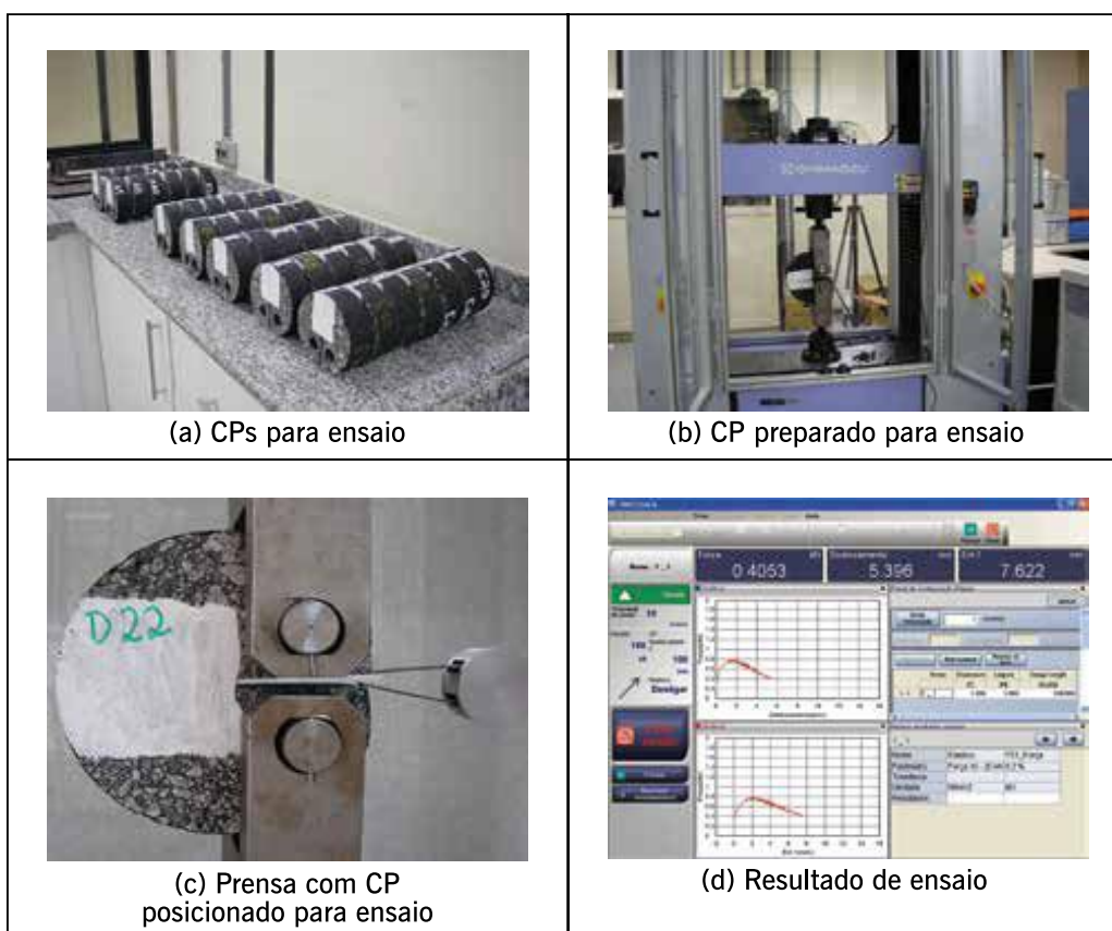
Figura 6.8 – Configuração do CP preparado para o ensaio de tração em disco circular com fenda, prensa e resultado do ensaio
