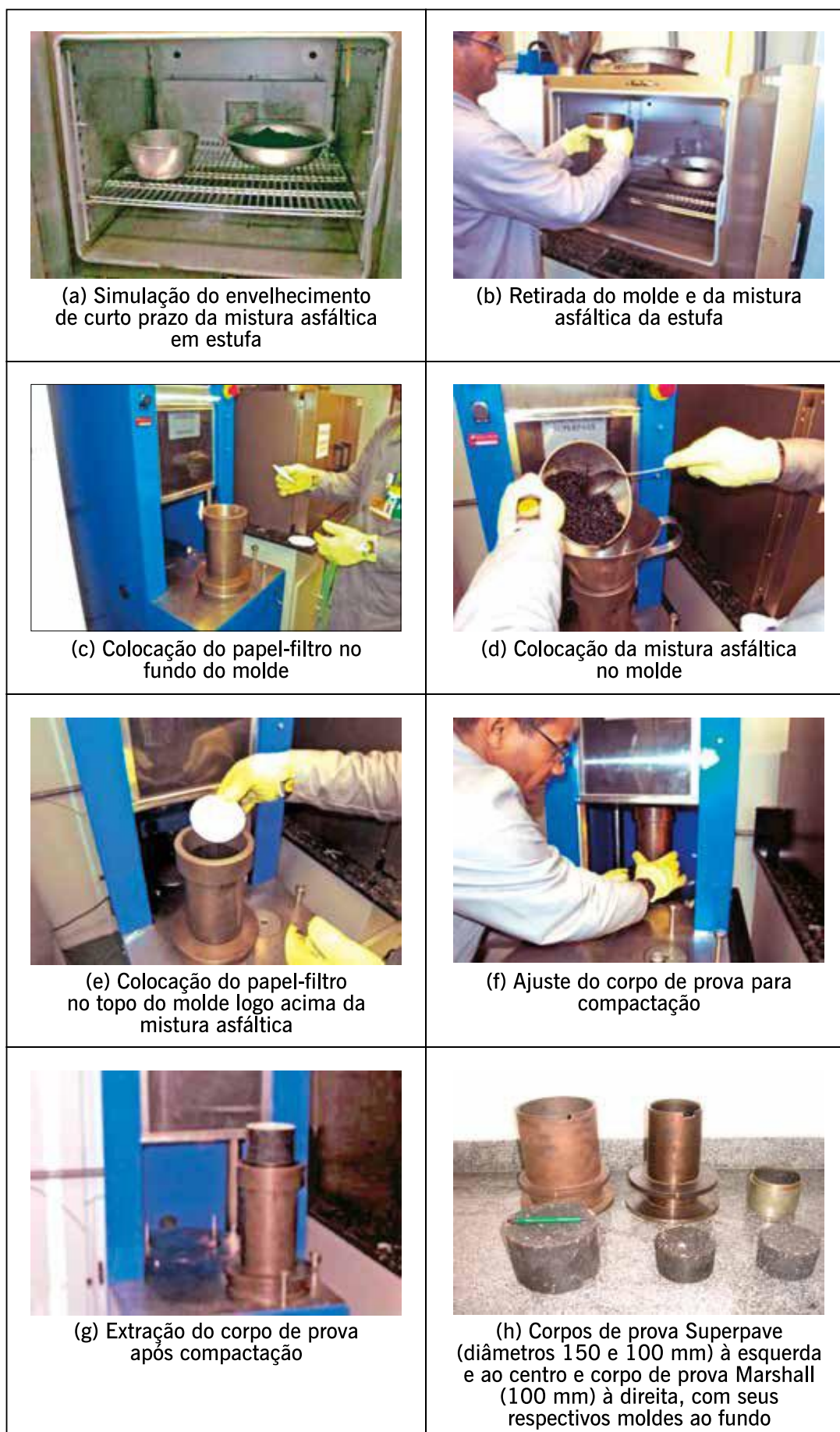
Figura 5.22 – Sequência do procedimento de compactação Superpave
