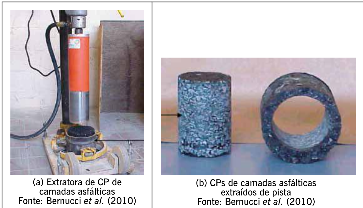
Figura 6.3 – Extração de CPs de pista para testes de RT em laboratório
