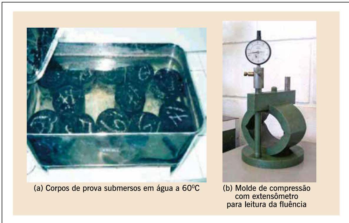
Figura 5.14 – Exemplo de corpos de prova submersos em banho-maria e molde de compressão
