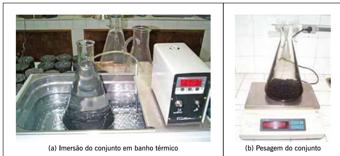
Figura 5.8 – Sequência final do procedimento para determinação da G_{mm}
