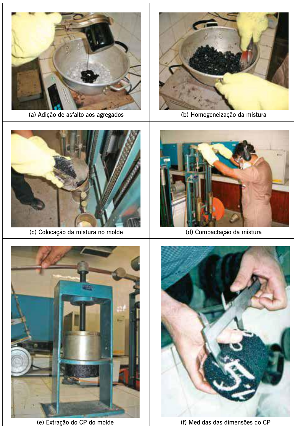
Figura 5.13 – Moldagem de CPs tipo Marshall em laboratório
