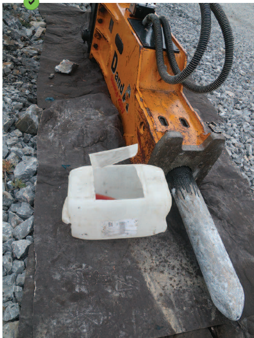
Équipement posé sur géotextile absorbant.
