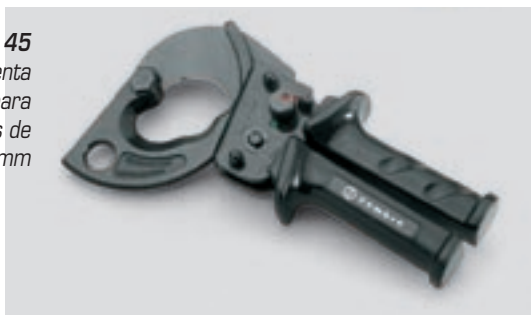
KT 4 Herramienta mecánica manual para corte de conductores de cobre y aluminio max Ø 52 mm Peso: 0,89 kg Longitud: 310 mm
