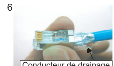
6 Insérez le câble dans le connecteur modulaire de façon à ce que la partie pliée du blindage entre dans le boîtier du connecteur. Le conducteur de drainage doit se trouver du côté de l'onglet du jack.
