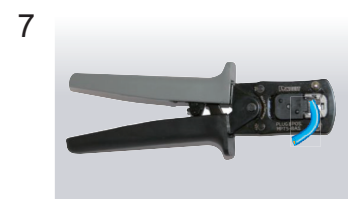
7 À l'aide d'un outil de sertissage spécial MPT5-8 (PANDUIT CORP.), sertissez le connecteur modulaire. Enfin, vérifiez le connecteur visuellement.
