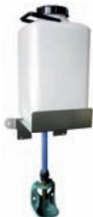
662 201 336 Kč 407 Kč Napáječka Model 70 Napáječka z prvotřídní nerezové oceli pro selata od narození do 15 Kg. 1/2" vnitřní závit ze shora. Hladký ventil z nerezové oceli, možnost nastavit až 5 možností průtoku vody – rychle a přesné nastavení.
