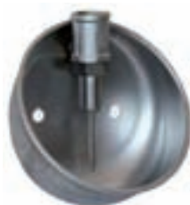
662 201 336 Kč 407 Kč Napáječka Model 70 Napáječka z prvotřídní nerezové oceli pro selata od narození do 15 Kg. 1/2" vnitřní závit ze shora. Hladký ventil z nerezové oceli, možnost nastavit až 5 možností průtoku vody – rychle a přesné nastavení.
